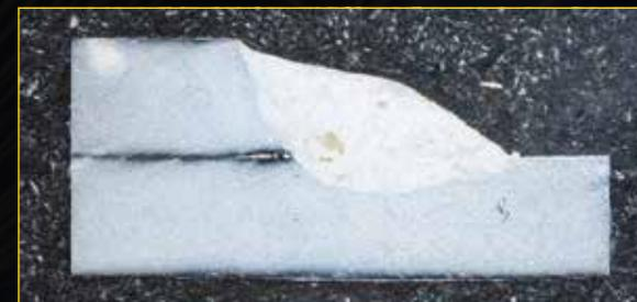
Поверхностная пористость отсутствует. Шов внахлест заполняется с трудом.
