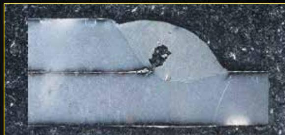
Большое количество поверхностных трещин и внутренних пор сварного шва.
